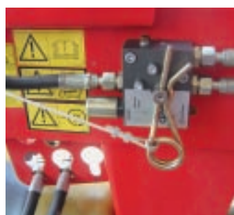
Montage ultérieur: système de sécurité pour le frein hydraulique.
