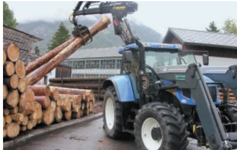
Le «TVT 155» utilisé en tant que tracteur forestier avec frontal, grue et pince, doit ici travailler dans des conditions difficiles.
