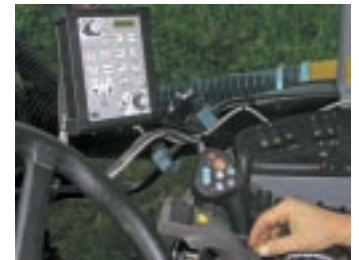
La transmission est commandée par un levier multifonctions.
