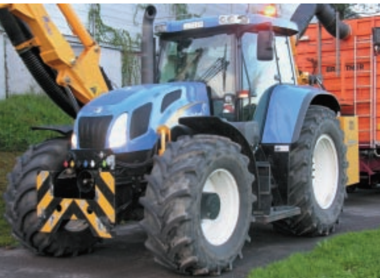
Sur demande, les prises hydrauliques peuvent être tirées à l'avant.
