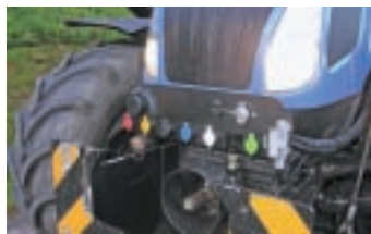
Sur demande, les prises hydrauliques peuvent être tirées à l'avant.
